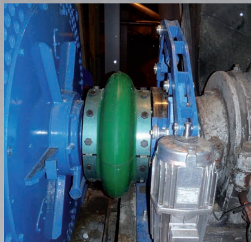
▲ Wentylator BAB 120 Zespół sprzęgłowo-hamulcowy TOP-M120BH 700kW/740 obr/min
