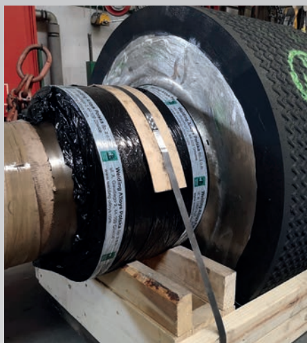
▲ Cementownie – dostawy i regeneracja walców pras rolowych.
